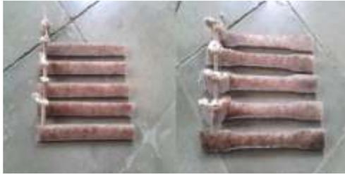
Gambar 8. Foto Spesimen Uji *Bending* Dan Uji tarik
