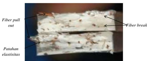
Gambar 5. Foto makroskopis daerah patahan spesimen uji *bending* dengan *holding time* 8 detik *temperature* 180°C
